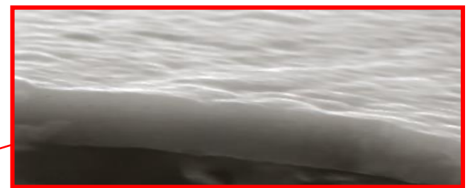
Abb. 1. Hartstoff der II. Generation H-SS5000/100G, (1,2µm) - abgeschieden mittels 3D Hybrid-AU-Quadro-CVD-Verfahren.
