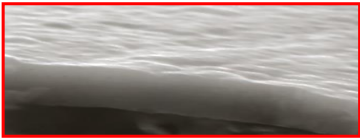
Abb. 1 Hartstoff der II. Generation HSS5600/100R, 1,2µm – abgeschieden mittels 3D HAUC-CVD-Verfahren.
